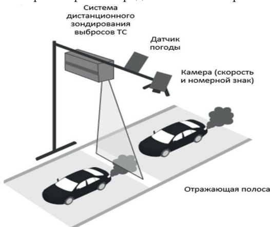
Рис. 2.16. Пример работы системы дистанционного зондирования выбросов от автомобильного транспорта [47]
