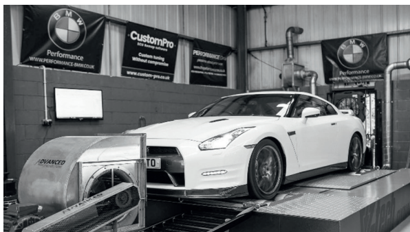
Рис. 2.13. Сертификационные испытания автомобиля на стенде с беговыми барабанами
